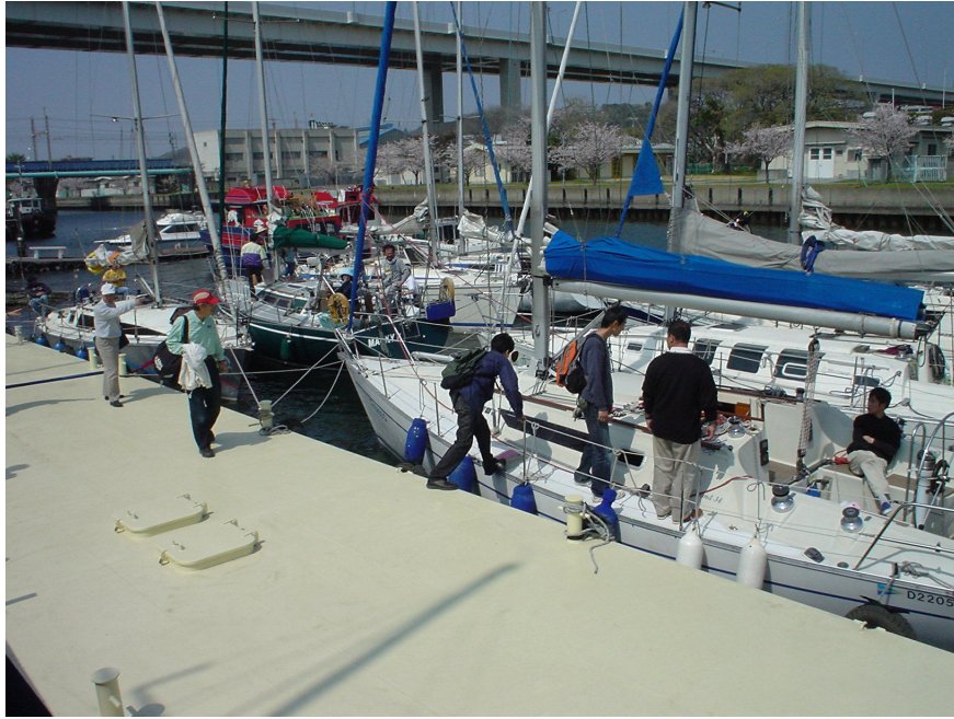
Photo. 2.39 ポンツーンからヨットに乗船する会員の風景 (浮き栈橋であるため干満による高低差がなく安全に乗船できる)
