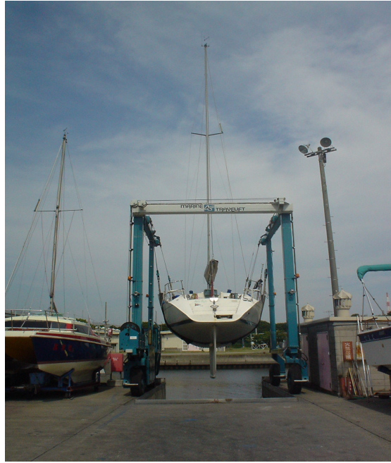
Photo. 2.30 トラベリフトによるクルーザーヨット下架風景 （ヨットをベルトで吊りあげて掘割に移動し、海上に降ろす）
