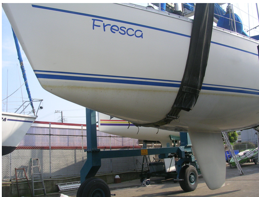
Photo. 2.29 トラベリフトによるクルーザーヨット下架風景 (ヨットをベルトで吊りあげて海上に降ろす)
