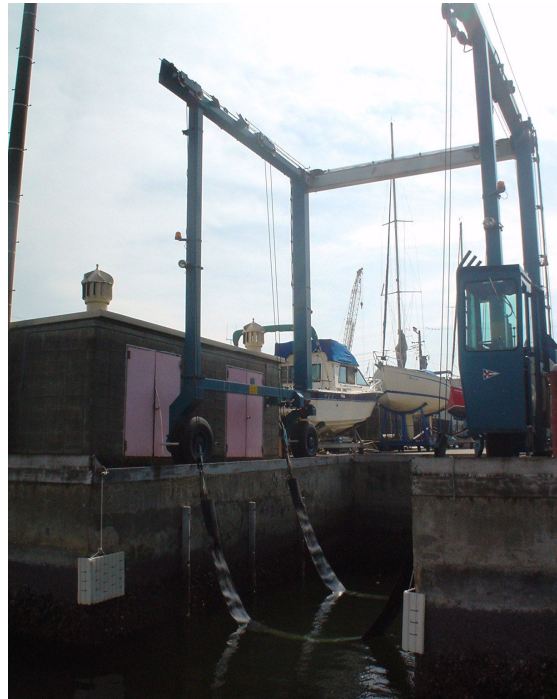
Photo. 2.31 上架準備状態のトラベリフト (掘割に艇をいれて上下架する)
